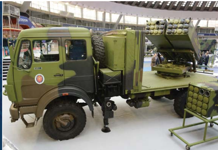
Лансер ракета самоходни вишецевни модуларни ЛРСВМ „морава“
